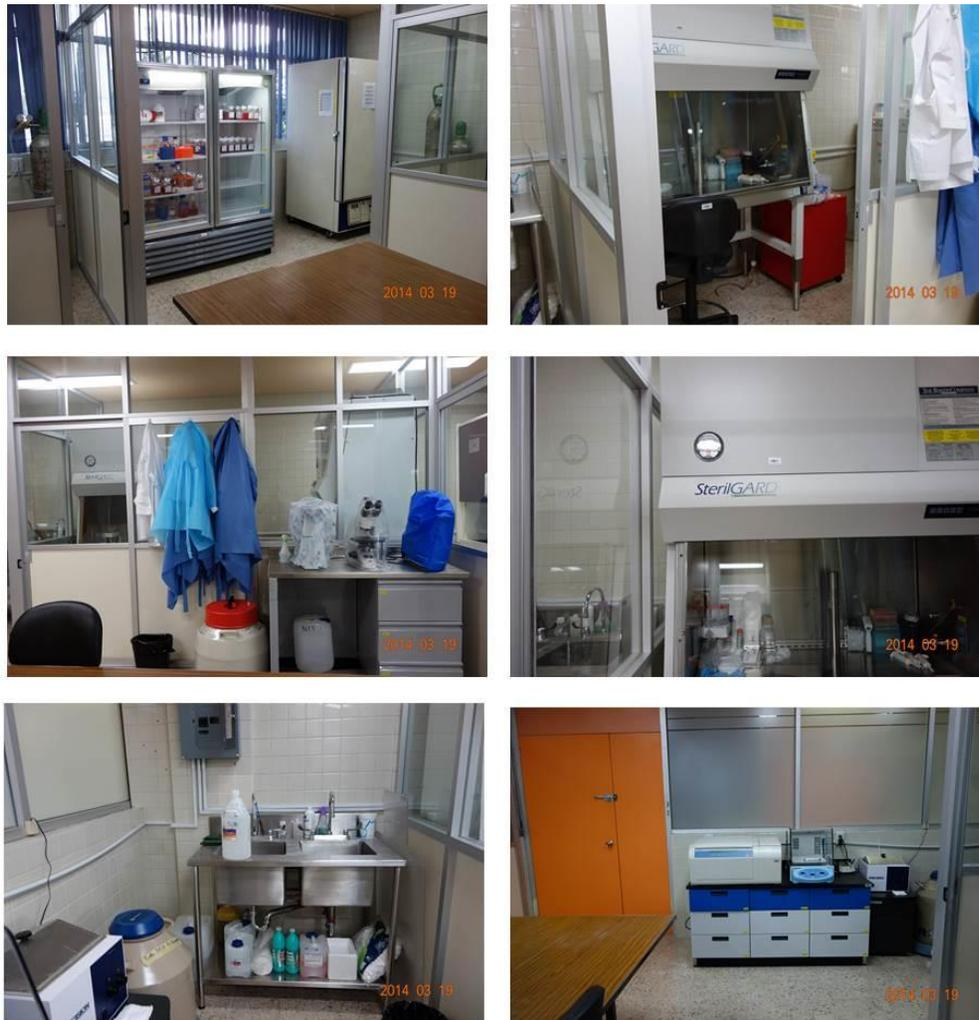
**Fig.** Unidad de cultivo de células nerviosas con cubículos independientes para campanas de flujo laminar, área de congeladores y refrigeradores para medios e insumos de cultivo, tanques de nitrógeno para preservación de células y equipos requeridos para cultivo comunes, (incubadoras de CO<sub>2</sub>, centrifuga y microscopios).
